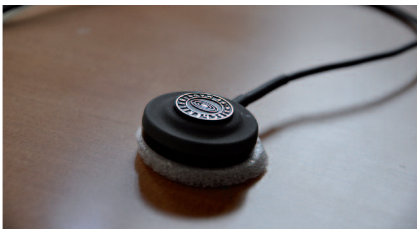
Mithilfe eines Schaumstoffrings kann das „Instrumenten-Stethoskop“ problemlos über das Soundboard geschoben werden, um den Sweetspot ausfindig zu machen.
