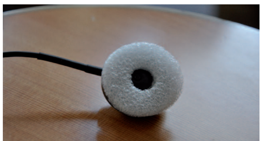
Der Schaumstoffring einer CD-Spindel eignet sich hervorragend, um ihn als Luftkissen für die Sweet-spot-Suche zu verwenden.
