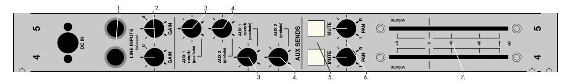
Il canale di linea "stereo" è effettivamente costituito da due canali mono indipendenti, ciascuno con i propri controlli. Può essere usato sia come un ingresso stereo che come due ingressi mono.
