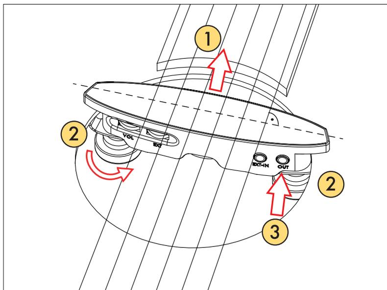
Collegare il MAGNETICO AG6 alla vostra chitarra è semplice e veloce. È possibile installare il pickup senza rimuovere le corde e fissarlo in tre semplici passaggi.
