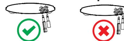
**Qualsiasi tipo di phantom power o bias tramite il cavo dello strumento può danneggiare M AG6. Se si utilizza il pickup con un amplificatore, un preamplificatore o un mixer SCHERTLER, assicurarsi che la funzione 10V sia DISATTIVATA.**
